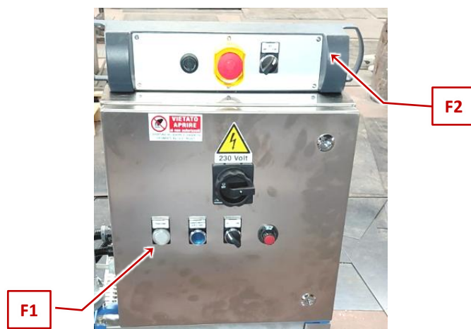
figura 4.9: Sistema di comando
