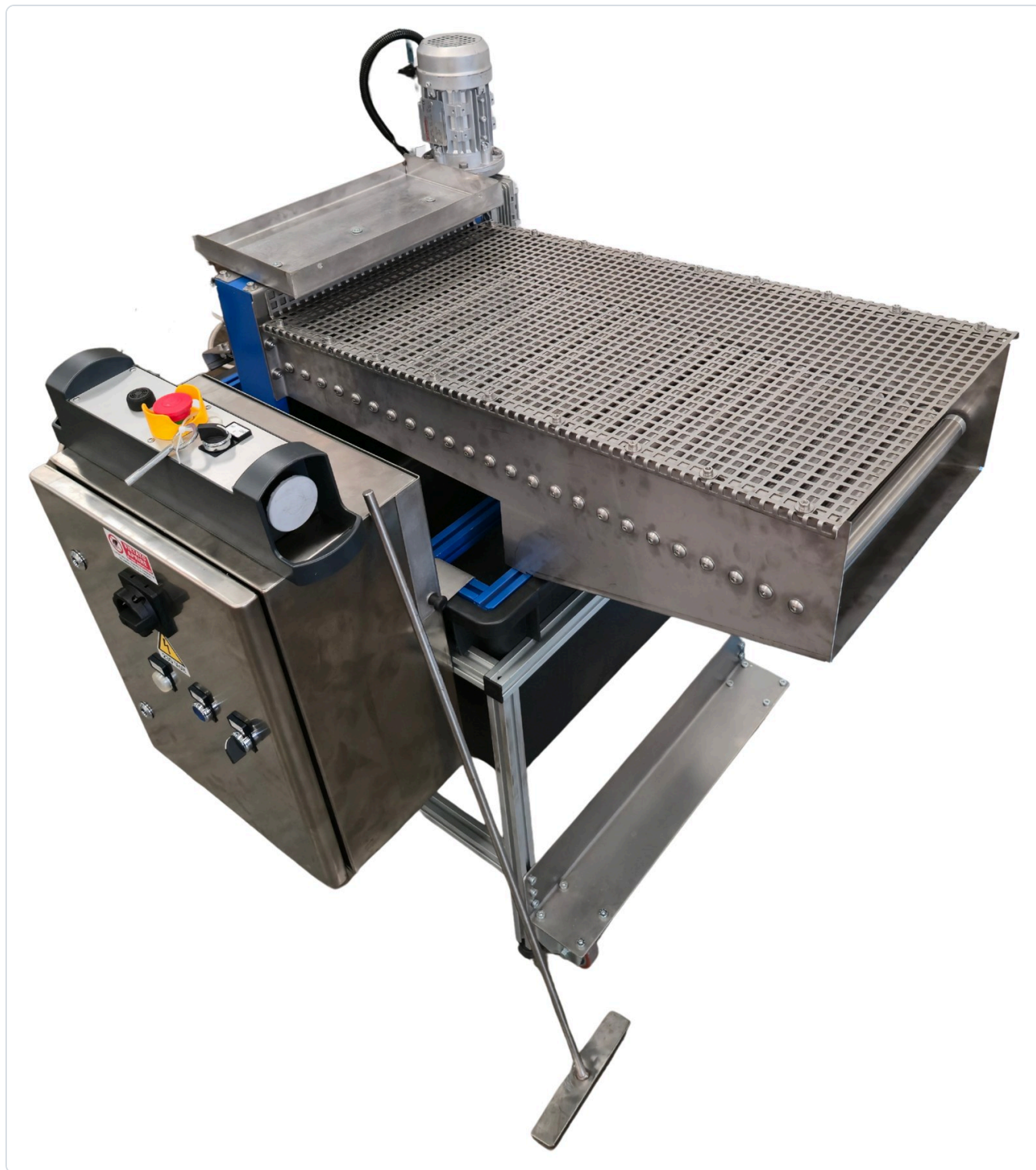
La bocca di carico con i rulli folli, il quadro elettrico con i comandi e la vasca di raccolta sotto il gruppo di strizzatura.
